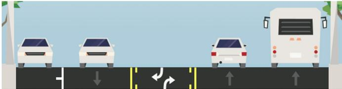
Carril de estacionamiento   Carril para conducir   Carril central para girar   Carril para conducir   Carril para buses (se permite girar a la derecha)
