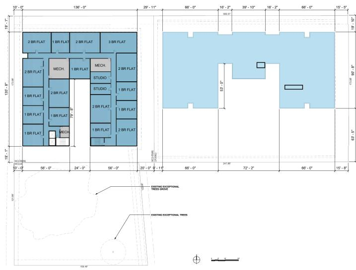
B1.2 TYPICAL UPPER LEVEL FLOOR PLAN
